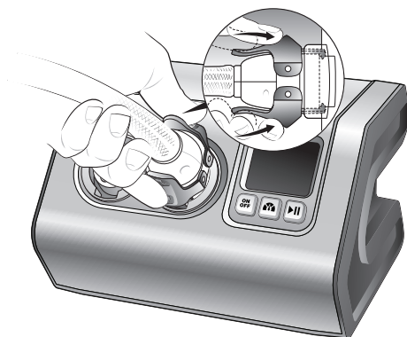
Figura 3.2.c. Cómo manipular el conector de la manguera correctamente
