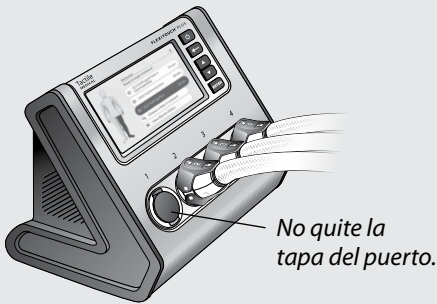
Figura 4.2.f. Conectores de manguera completamente acoplados cuando se recetan tratamientos de pierna completa y brazo-hombro
