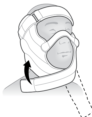
Figura 8.4.d. Fije los sujetadores de gancho de la solapa exterior de la barbilla izquierda
